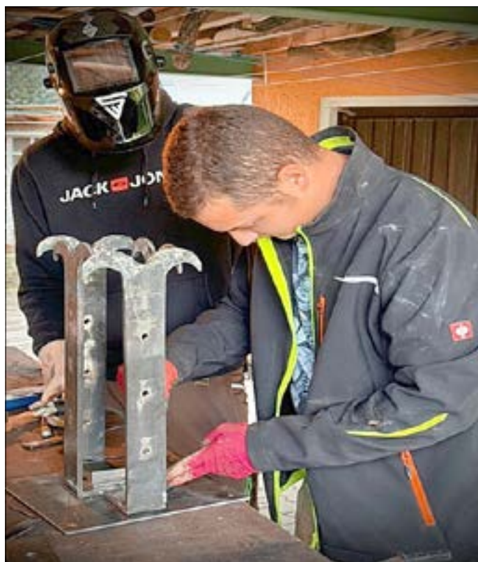
V. l. Max Wendler, Albert Grunewald beim Schweißen der Balkenschuhe, Foto: RJN
